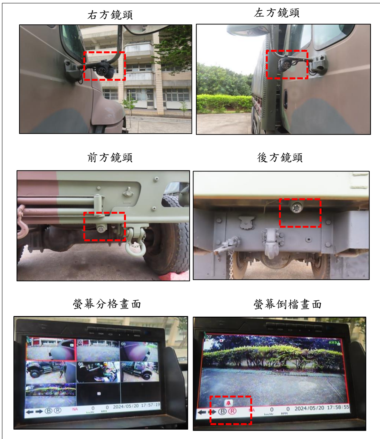
圖 9-3.5 噸載重車環景系統裝設位置
