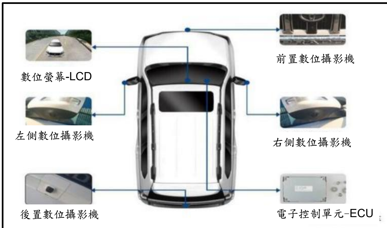
圖 3-PVM360 度環景顯影系統架構
