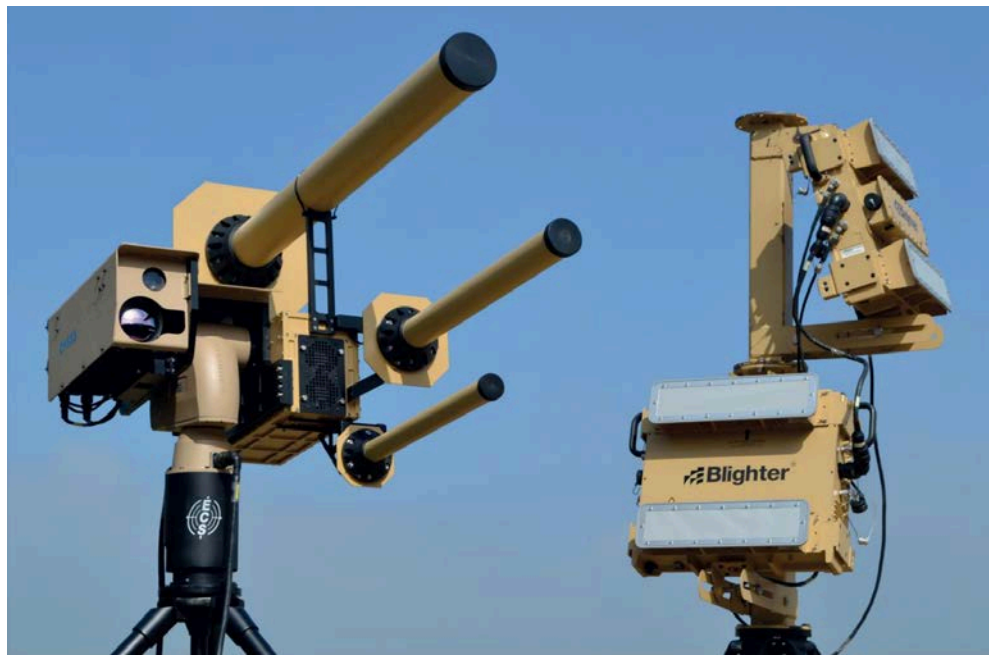
反無人飛行載具防禦系統旨在偵測、追蹤、鑑別及干擾無人機，最遠可達八公里範圍。(Source: Blighter Surveillance Systems Ltd.)
