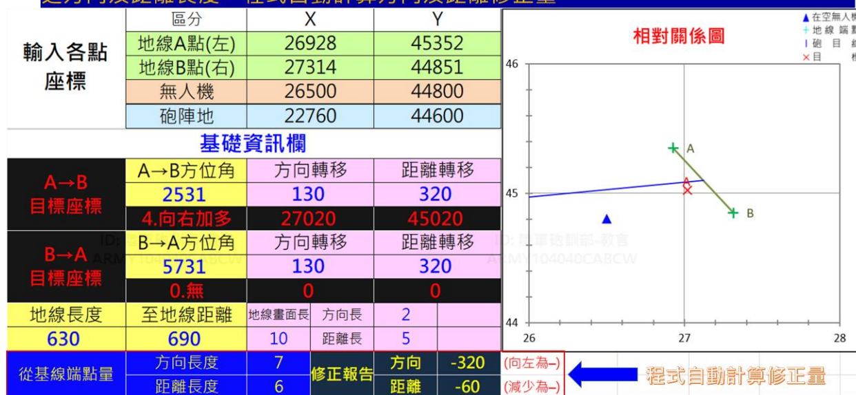
圖 16 以基準地線板及程式輔助作業示意圖
