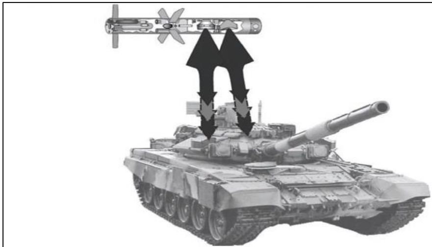
圖 13-TOW 2B 型拖式飛彈攻頂模式
