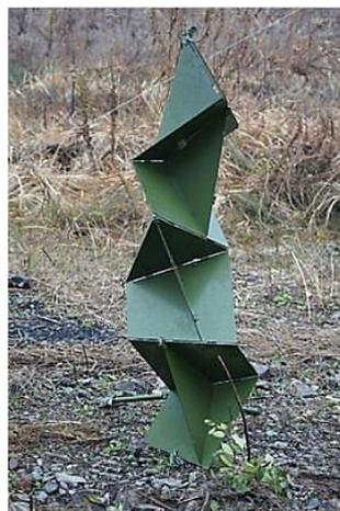
圖 18 角反射器
