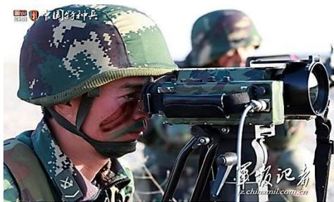
圖 7 85 型雷射測距機
