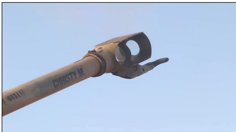
圖11 M777 A2式155公厘牽引砲已將牽引環位置改良至砲口前方
