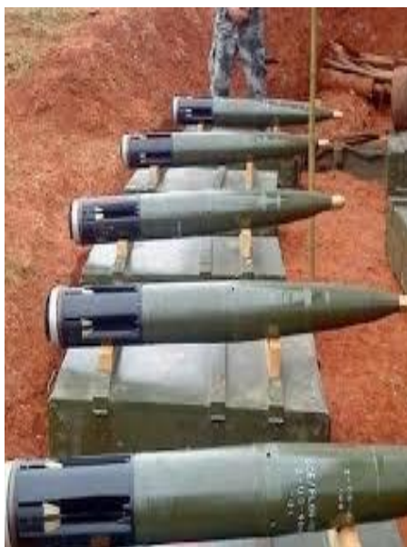
圖 8 GP-155B 型 155 公厘 GPS 導引砲彈
