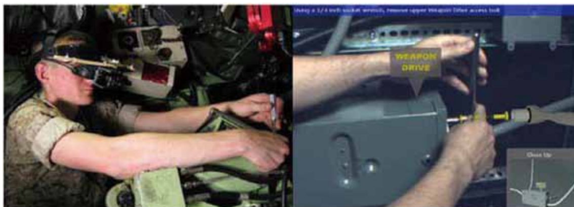
圖3 利用擴增實際技術維修狀況
