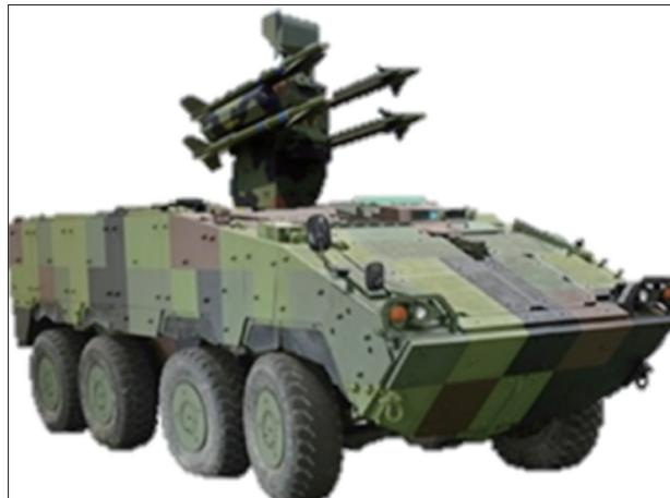
圖五 車載劍一防空飛彈系統（捷羚防空飛彈系統）（左）；模擬發射平臺的八輪甲車（右）
