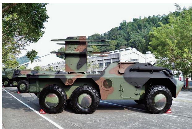
1988年陸軍戰甲車發展中心再度派員進行設計改良作業，1992年製造出第二輛6×6裝甲原型車，全車裝甲覆蓋，車尾加裝浮渡用的推進器，此原型車始命名為CM31，構型與2號原型車外觀極為相似，之後被改成短程防空導彈發射車，故現存構型已變更為飛彈發射車(如圖二左)。CM31戰鬥重量15.5噸，編制駕駛與車長，可運載10名士兵，主要武器是一挺12.7公厘機槍，搭載美國康明斯(Cummings) 350匹馬力柴油引擎，最高路速每小時100公里，最大航程600公里。
