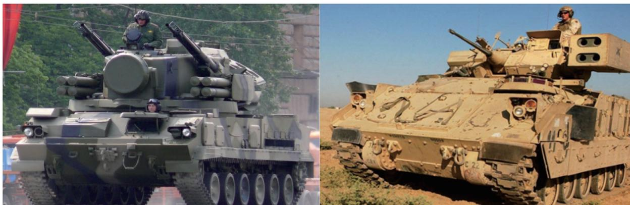
圖八 2K22 通古斯卡-M與2008年莫斯科勝利日閱兵儀式（左）；加裝刺針飛彈的M2防空型稱為「M6」後衛，2005年10月3日攝於伊拉克戰爭（右）（資料來源：同註36、37）
