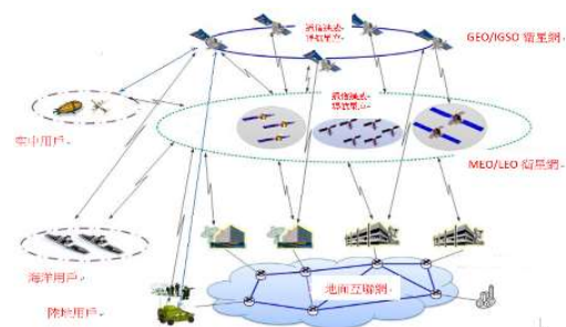
圖 11 天基網系統與地面 互聯網構聯示意圖
