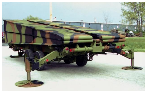
圖 5 英國 BAE 公司拖載式橋樑(Trailer Launched Bridge-TLB)
