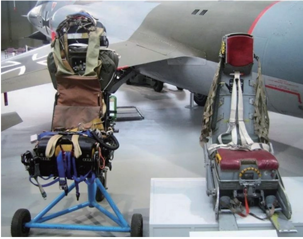
圖5 F-104使用之彈射座椅C-2(右)及馬丁·貝克GQ7A (摘自 http://www.ifuun.com/ )
