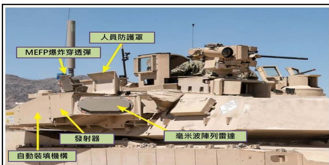
圖8、戰利品主動防禦系統示意圖-1
