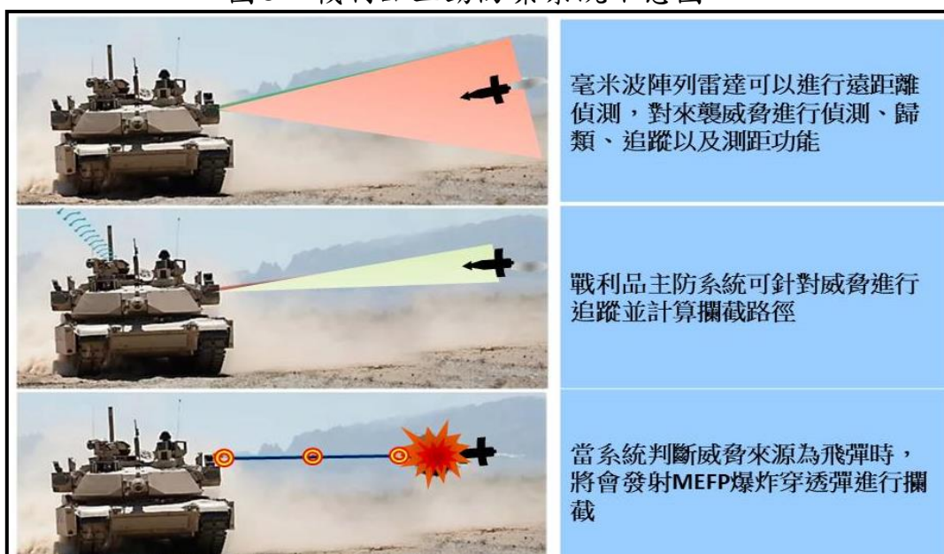
圖9、戰利品主動防禦系統示意圖-2
