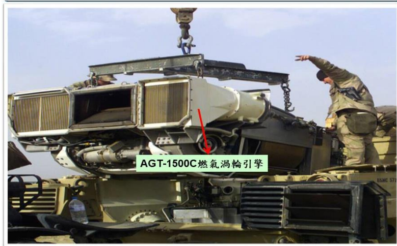
圖6、AGT1500C燃氣渦輪引擎示意圖
