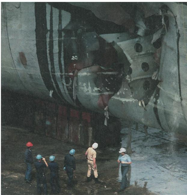
檢驗人員在位於巴林的乾塢中，檢查舷號10號的美海軍兩棲攻擊艦「的黎波里號」(USS *Tripoli*, LPH-10)的受損情形。諷刺的是，該艦是在1991年2月18日於「沙漠風暴行動」(Operation Desert Storm)期間，擔任空中水雷反制作戰旗艦時誤觸伊拉克水雷。舷號59號的飛彈巡洋艦「普林斯頓號」(USS *Princeton*, CG-59)，也在同一天觸發水雷。(Source: USN/Joi Gawlowicz)
