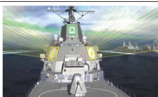
圖三：雙波段AN/SPY-6雷達艦艇配備示意圖
