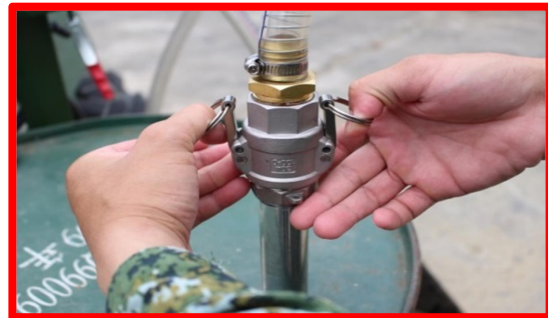
圖 23 安裝加油管作業作業 2
