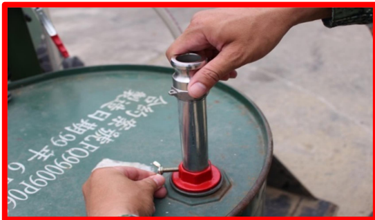
圖 22 安裝加油管作業作業 1
