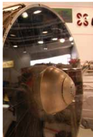
MAKS2009展出的117S的入口結構特寫。轉子整流罩頂面仍為球面，但側壁分為前後兩段，分別朝不同方向傾斜，能將來自前方與後方的雷達波往進氣道方向反射。(作者攝)
