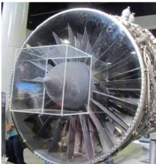
MAKS2013展出的117S的入口結構已有顯著變化。轉子整流罩頂端為尖錐型，且整流罩、導向葉片、入口外殼都是藍灰色，應是用了複合材料或吸波塗料。(Patti Ho)
