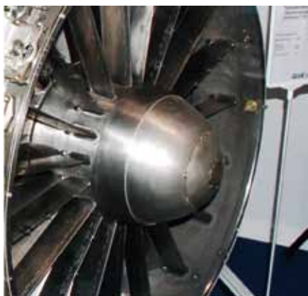
MAKS2007展出的117S的入口結構特寫。轉子整流罩側壁為圓柱狀，頂面為球面，且整個入口結構都是金屬。(作者攝)
