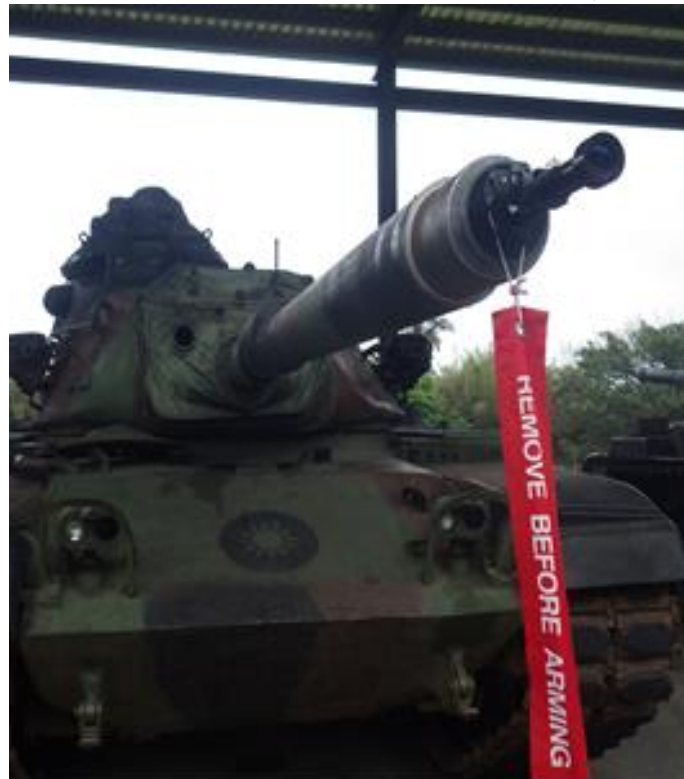
圖 21、安裝 M26A2 砲口規正儀於戰車砲口上
