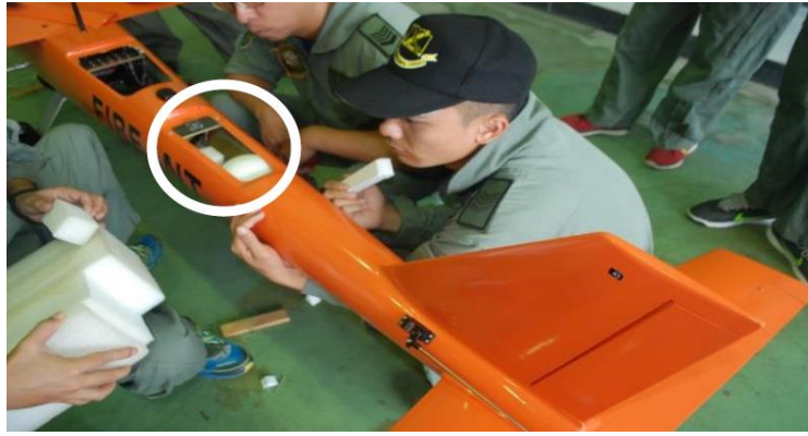
圖十五 靶機加掛輻射增波器
