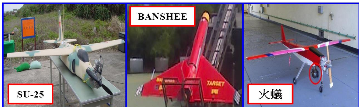
圖十四 野戰防空實彈射擊各式 1/5 縮小靶機
