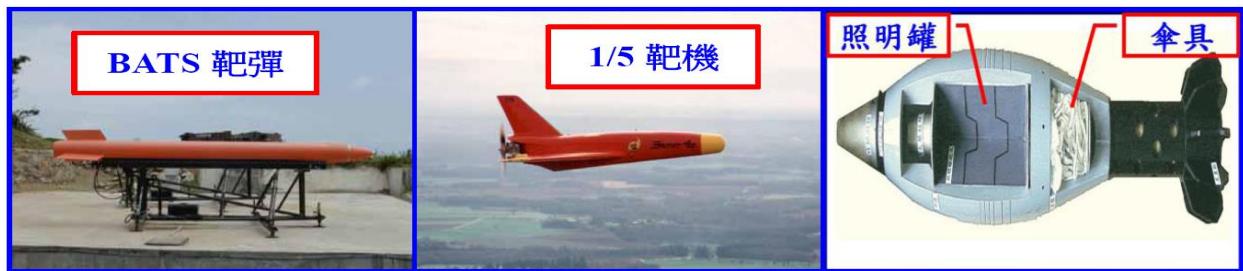
圖十二 復仇者飛彈系統實彈射擊空中靶標
