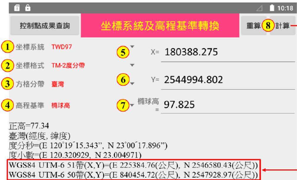
圖九 新型「測地電算機」(IMT - 8R) 將「頂山」II 等衛星控制點 TM2 度換算為 UTM6° 方格座標
