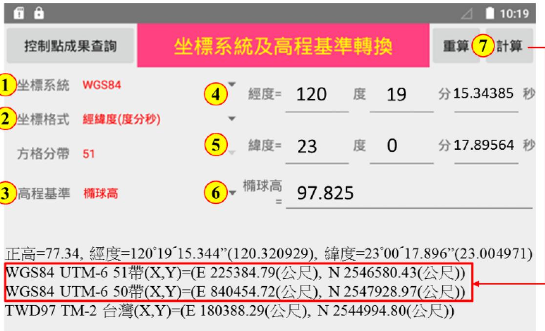
圖七 新型「測地電算機」(IMT - 8R) 地理座標換算 UTM
