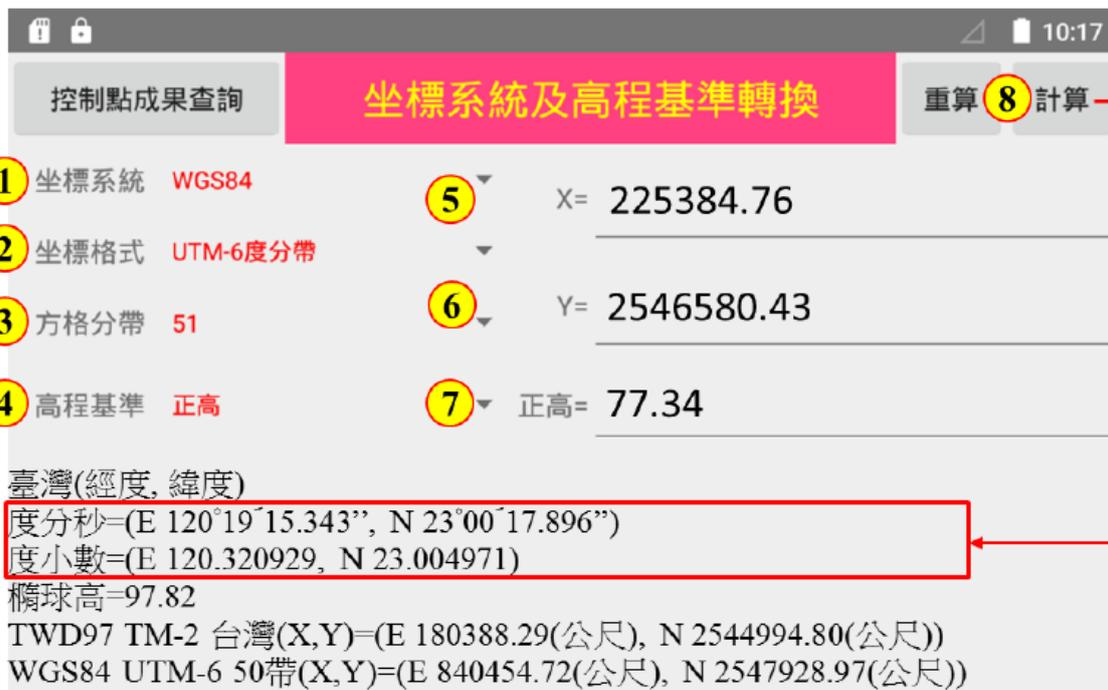
圖八 新型「測地電算機」(IMT-8R)將「頂山」II等衛星控制點 UTM6° 方格座標換算為地理座標
