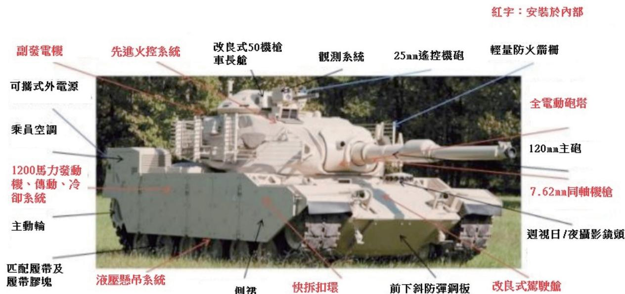
圖五 美國L-3 CPS系統改裝示意圖
