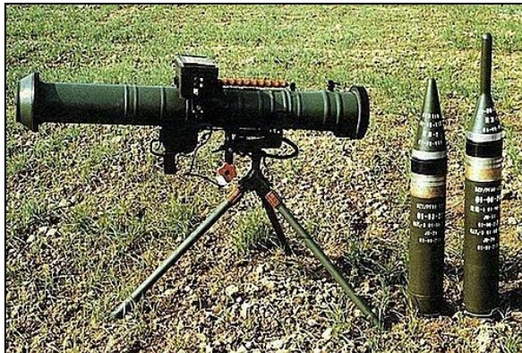
圖 53、PF98 式 120mm 火箭筒武器系統
