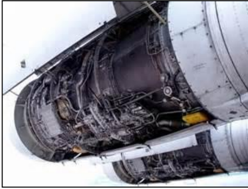
圖 1、D-30 P-2 渦輪風扇發電機
