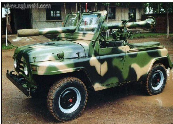
圖 43、車裝 75 式 105 毫米無後坐力砲
