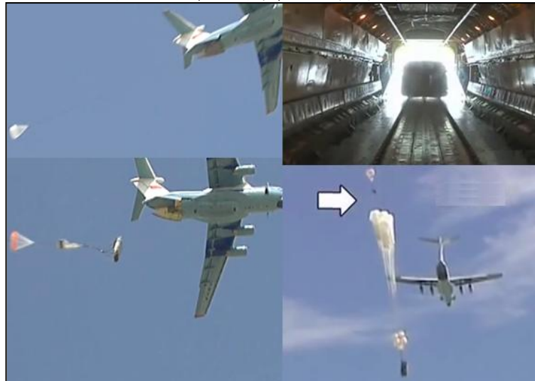
圖 26、傘兵戰車離開飛機過程
