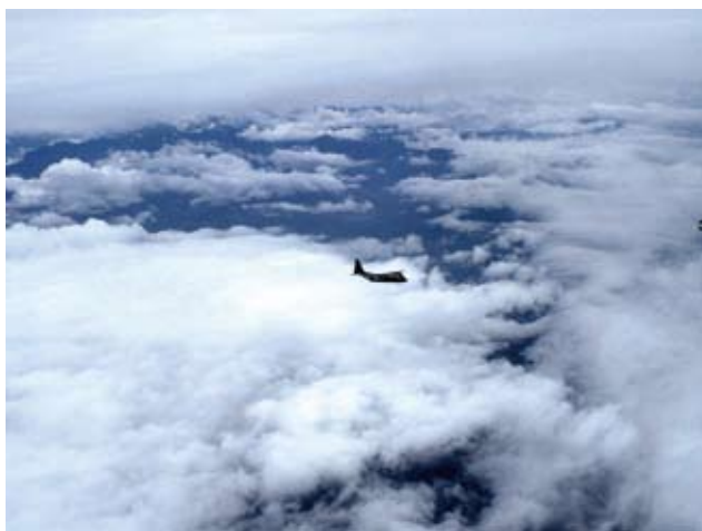
圖四 空中人工增雨作業進行種雲蒐尋，需以裂雲（或密雲）為主，以利增雨效益的提昇
