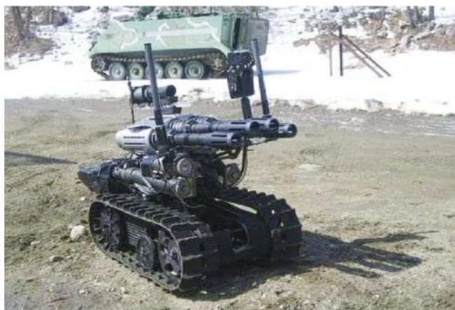
圖七 安裝於「魔爪」無人地面車輛上的「金屬風暴」武器系統
