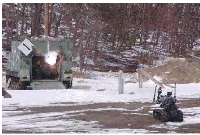
圖八 「魔爪」「金屬風暴」武器系統火力試驗驗證
