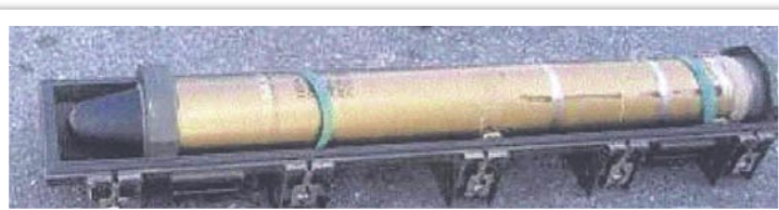
圖一 M 712銅斑蛇 (Copperhead) 155公厘導引砲彈
