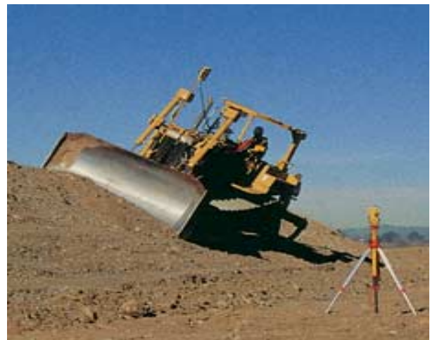
圖 8: CB420 型推土機 GPS 控制箱實體圖 圖片來源：Trimble 公司產品目錄
