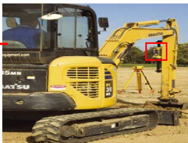
圖 4：挖土機配裝 Spectra LR60 雷射激光接收器實體圖
