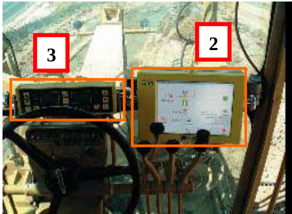
圖 22：平路機整合系統三大原件配置圖
