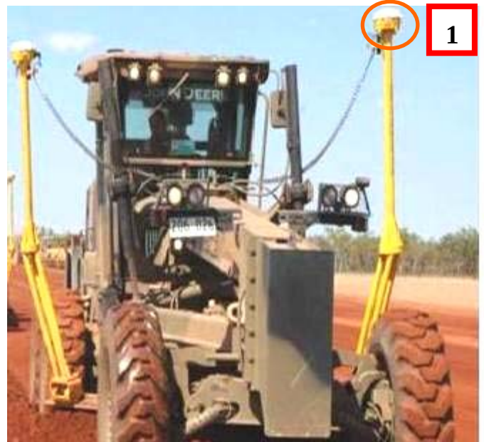
圖 22：平路機整合系統三大原件配置圖
