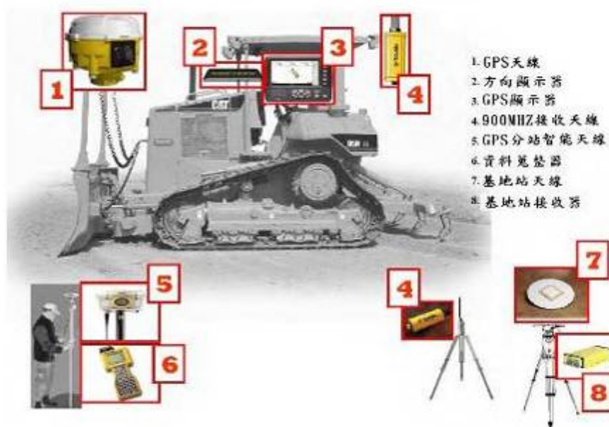
圖 21：推土機整合系統八大原件配置圖
