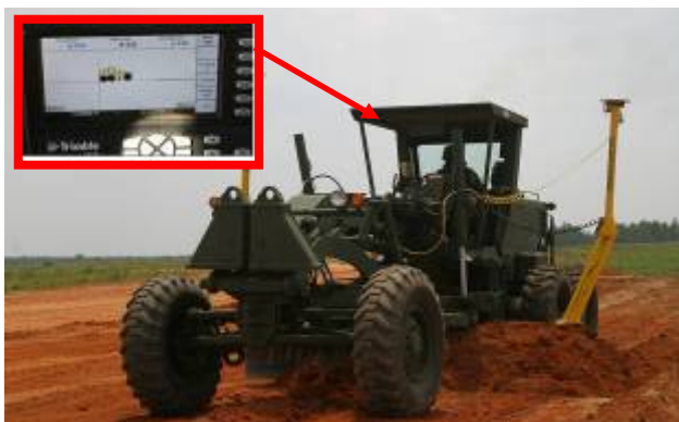
圖 24：各機械作業手依據顯示器數據作業示意圖
