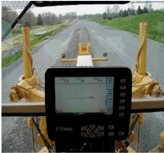
圖 7：平路機 GPS 控制箱及內建軟體圖 圖片來源：Trimble 公司產品目錄
