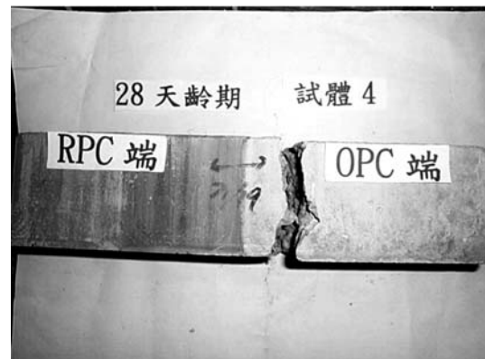
圖 11 RPC 修補砂漿的結合斷面試體破壞狀況
