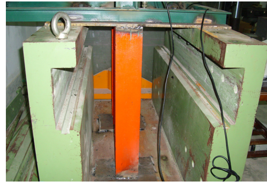
圖5. 防爆門門框底部束制情形。
