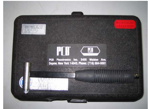
圖10. PCB 086C03型衝擊鎚[14]。
