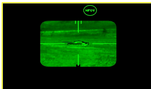
圖 8：熱顯象瞄準具顯像示意圖
