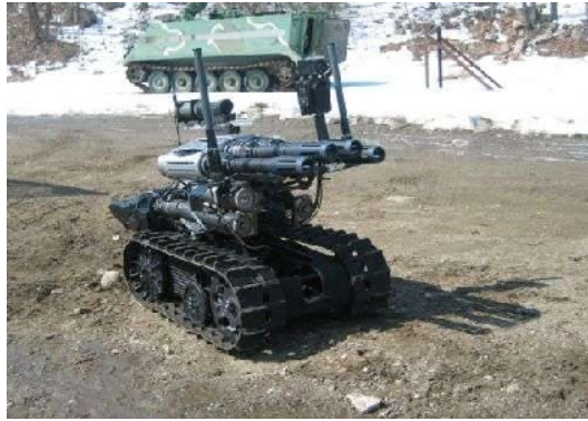
圖七 安裝於「魔爪」無人地面車輛上的「金屬風暴」武器系統
