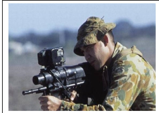
圖四 AICW 是將斯泰爾 5.56 公厘突擊步槍和金屬風暴 40 公厘榴彈發射器整合在一起的一種綜合式武器系統
