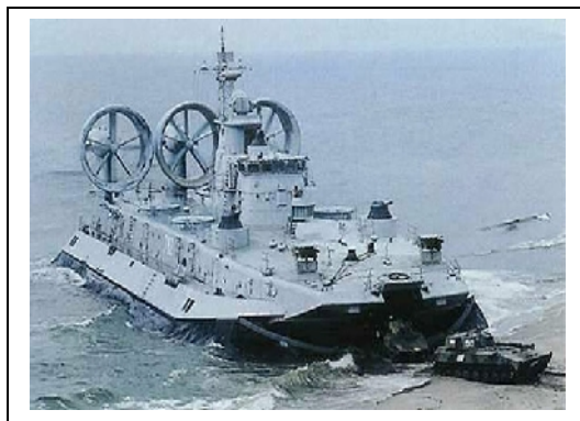
圖六 野牛級大型氣墊船搭載之戰車
