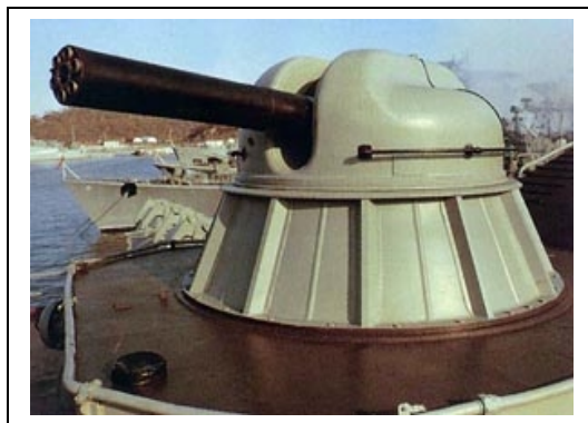
圖五 野牛級氣墊船 AK-630 艦載火炮系統
