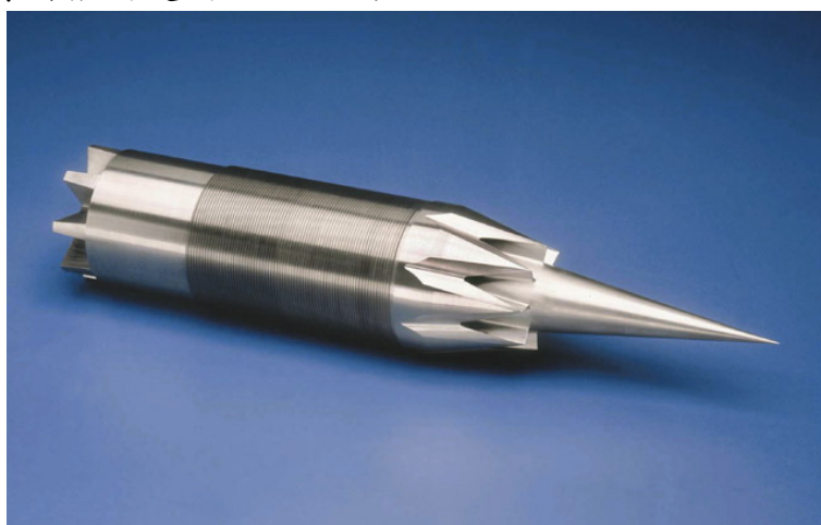
圖13 該砲彈於測試時以超音速衝壓發動機推進30毫秒時間
