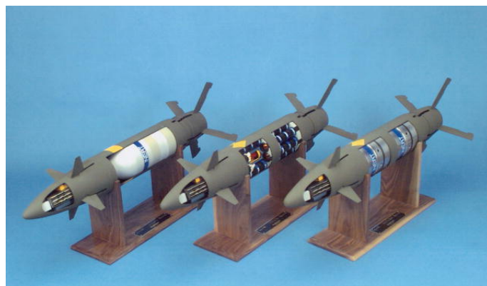
圖24 XM982“石中劍”GPS/慣性導航增程導引砲彈三種模組(左起)：單一彈頭、雙效子母彈、薩達姆(SADARM)彈
