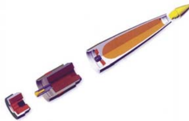
圖27 新型155公厘火箭助推/底排砲彈結構圖
