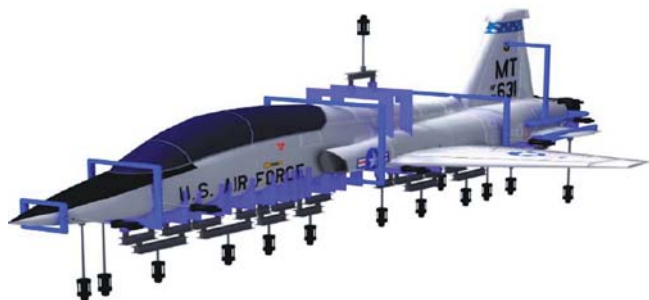
圖二 T-38 型機機身負載施加配置示意圖[1]
