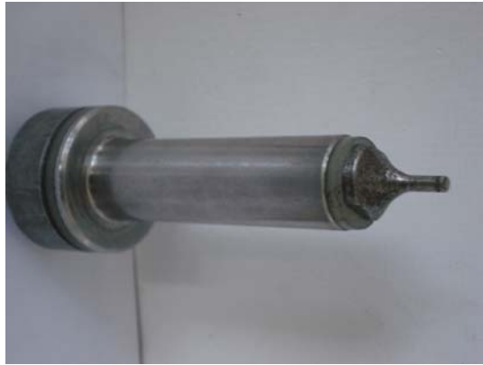
圖十二 發火機尖端磨損
