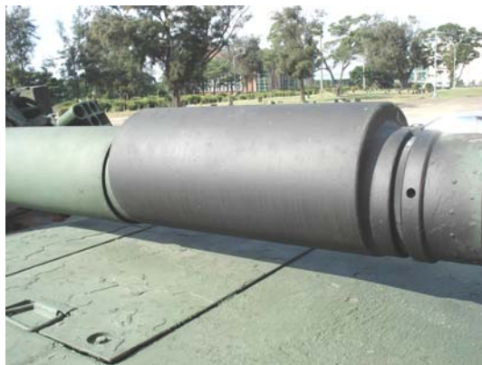
圖六 砲膛排煙室
