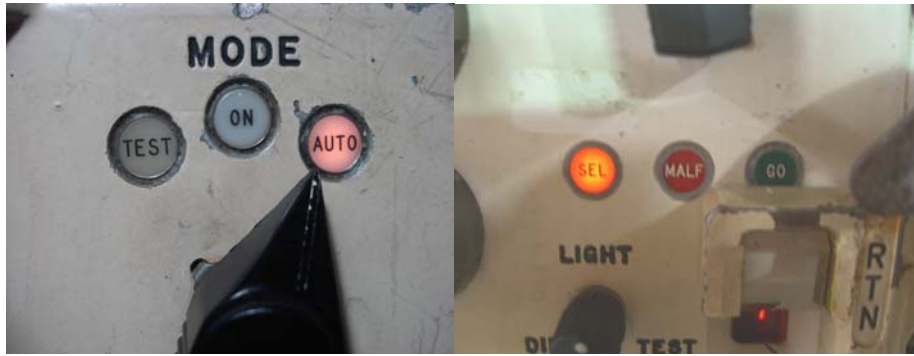
圖三十三 模式開關扳「AUTO」 圖三十四 M60A3 戰車雷射 SEL 燈亮起
