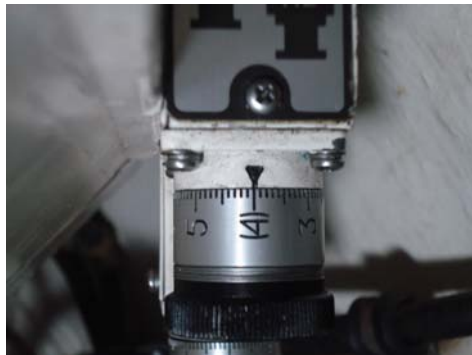
圖三十二 熱像鏡調整螺分劃環
