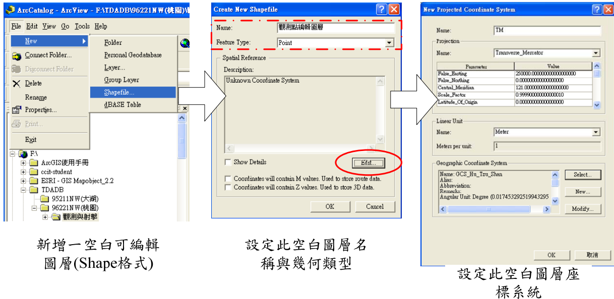
圖十三 設定武器點編輯圖層流程(資料來源：作者繪製)
