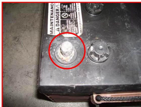
圖十四 電樁頭融解示意圖
