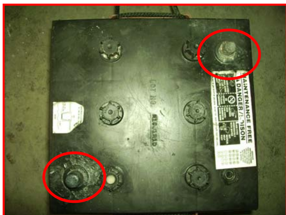
圖十三 電樁頭融解示意圖
