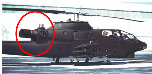
圖為 AN/ALQ-144 紅外線反制器裝設於攻擊直昇機位置
