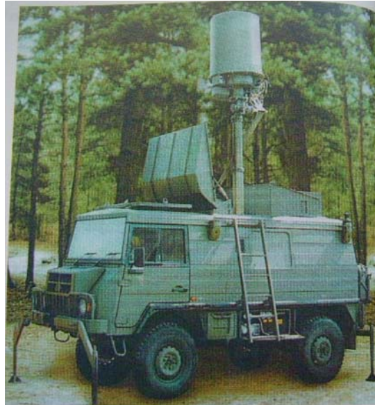
圖為據悉用於「臨時非通信電子支援」MEERKAT--S 型電子支援/電子情報系統的感應器站構型。(本照片翻拍自國防譯粹 32 卷 12 期 p. 52)
