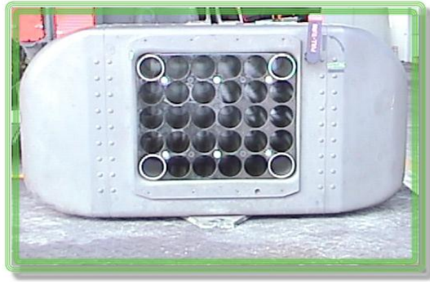
圖為 AN/ALE-39 電子反制拋射器
