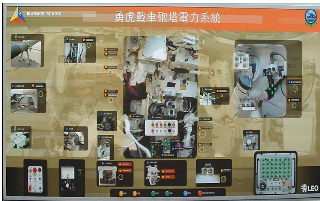
圖十 砲塔電力系統面板
