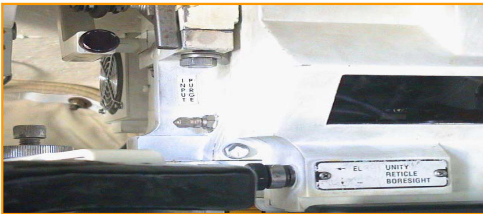
圖十四 未定期實施氮氣充填，導致內部組件受潮損
