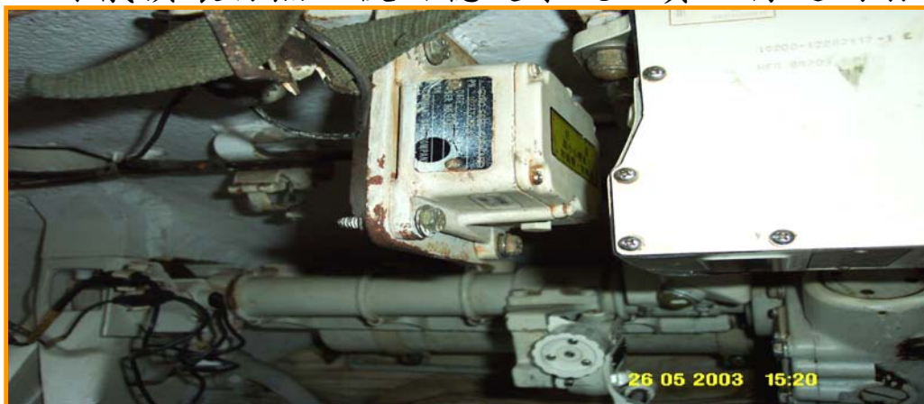
圖二十三 陀螺儀超過壽限損壞
