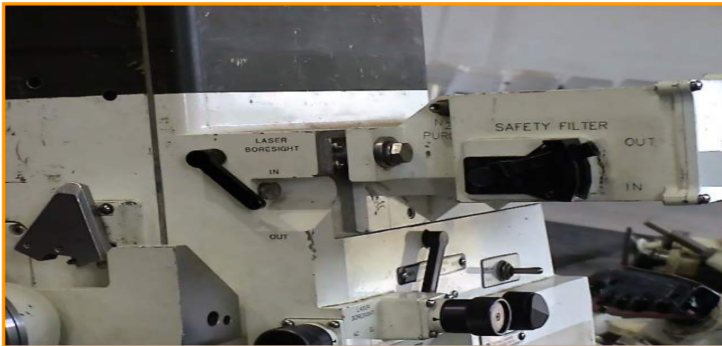
圖十七 未定期實施氮氣充填，導致內部組件受潮損
