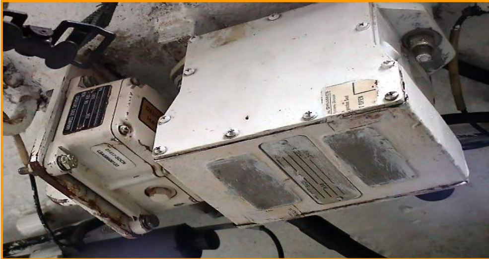
圖二十七 陀螺儀地線鬆脫及穩定系統周邊線簇
