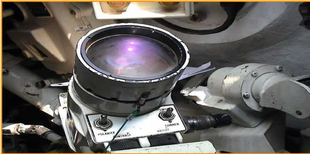
圖十 未定期實施氮氣充填，導致內部組件受潮損壞
