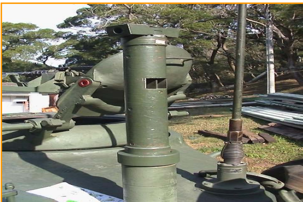
圖二十 橫風感測器安裝不當將造成損壞
