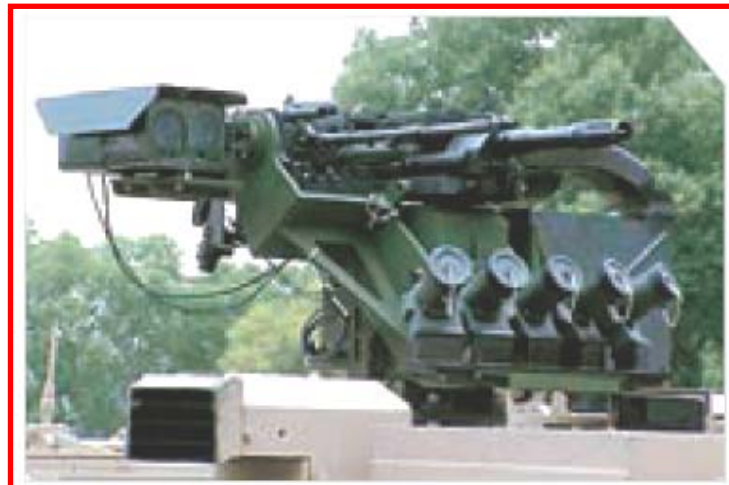
圖六 遙控 CIS 型榴彈機槍 40AGL 及 7.62mm 同軸機槍
