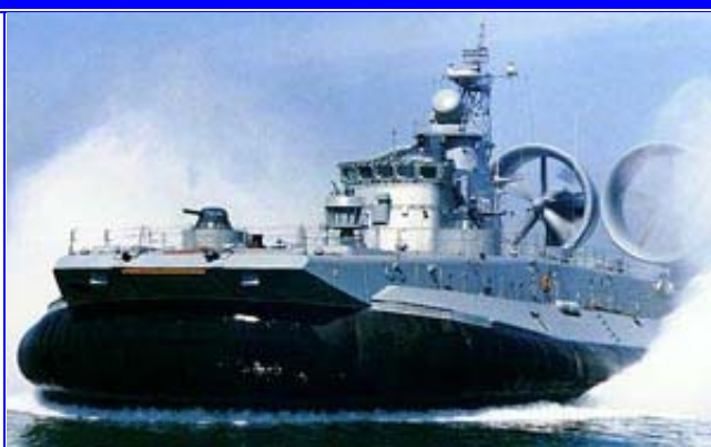
圖10－野牛級氣墊登陸艇最高航速60節
