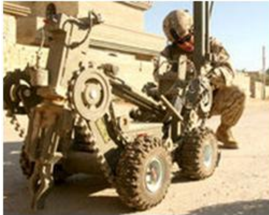
圖十七—美軍士兵在伊拉克正在檢查用於專門處理掩埋土製炸彈的機器人。
