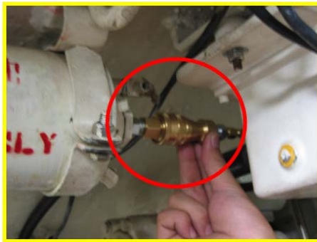
圖十一：液壓油加注作業
