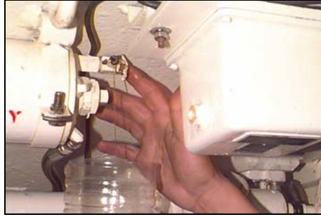
圖十二：制退機油補充器少量放洩 (M60A3TTS 戰車操作手(上冊) 1-106 頁)
