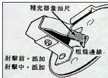
圖十三：補充器量油尺-兩邊有齒 (CM11/12 戰車操作手 上冊 1-105 頁)
