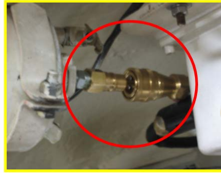
圖十：安裝快速拆裝接頭
