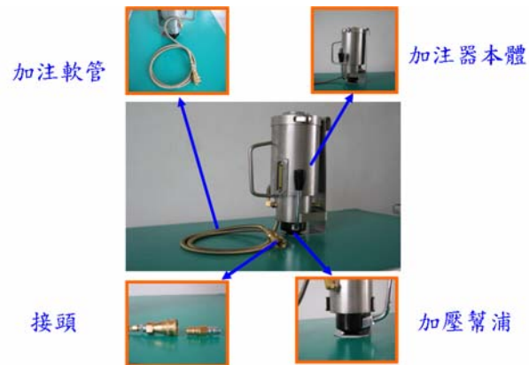
圖八：戰車制退機油補充加注器組成
