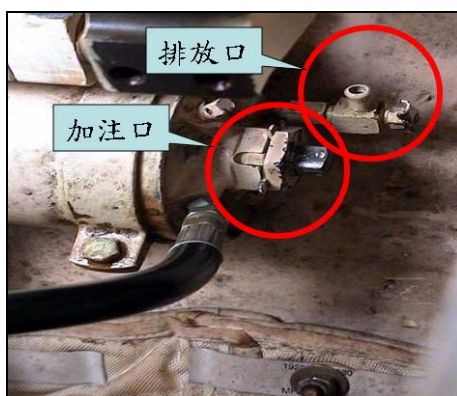
圖七：制退機油補充器的加注口及排放口
