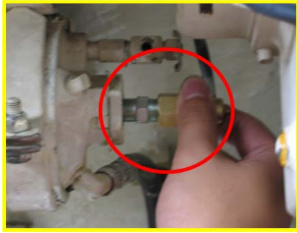
圖十：安裝快速拆裝接頭
