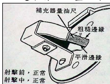
圖十四：補充器量油尺-一邊有齒、一邊平滑 (CM11/12 戰車操作手 上冊 1-106 頁)
