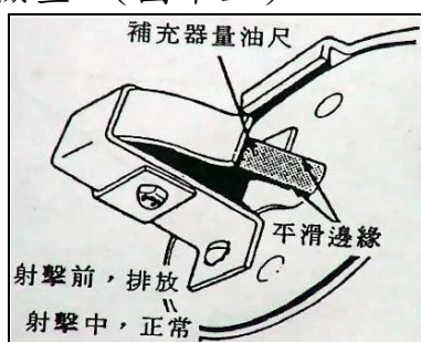
圖十五：補充器量油尺-兩邊平滑
