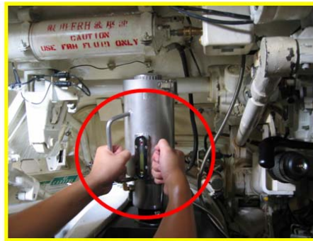
圖十一：液壓油加注作業
