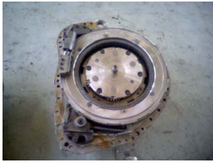
圖 17：多片 溼式離合 器及制動 帶（二）
