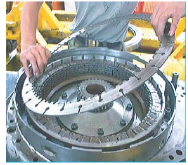
圖 17：多片 溼式離合 器及制動 帶（二）
