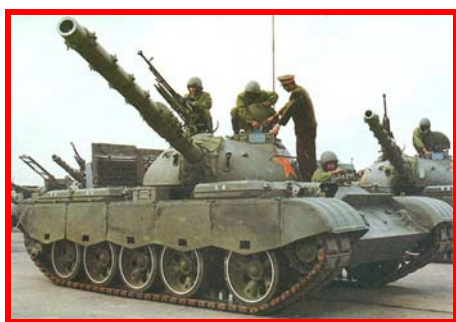
圖八：79 式配備仿英製的 105mm 戰車炮
