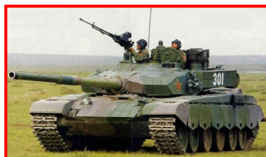
圖三十一：99 式砲塔有類似豹二 A5 的楔型裝甲
