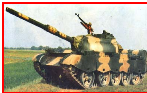
圖九：79 式外觀同 69 式但砲塔無外掛的測距機
