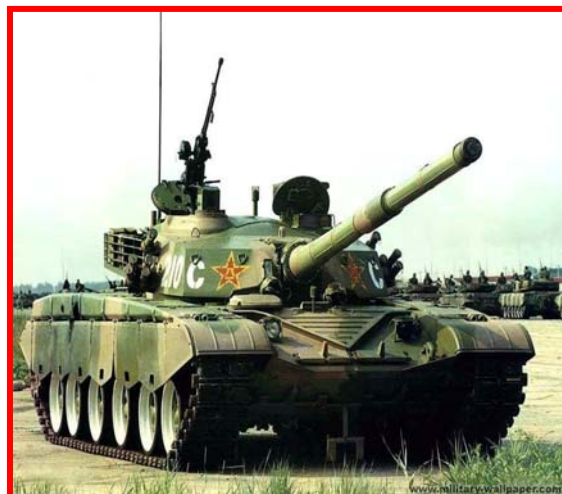
圖二十四：98 式砲塔與 99 式戰車有明顯區別
