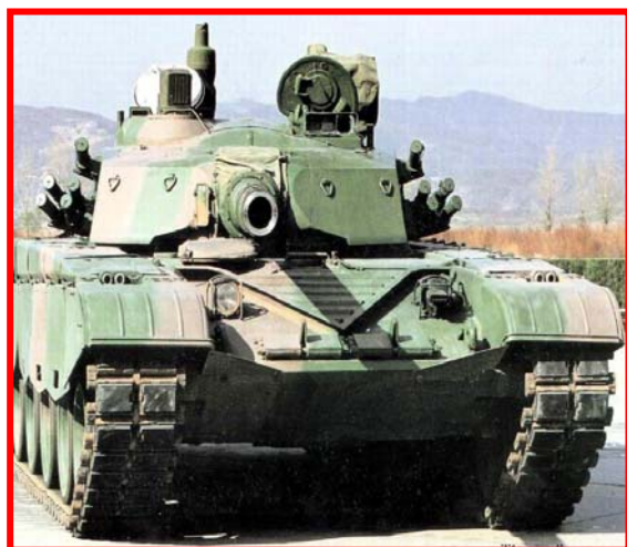
圖二十三：98 式在底盤與俄羅斯 T-80 戰車雷同
