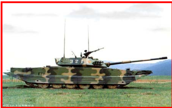
圖三十：63A 式的浮游裝置可增進其泛水速度
