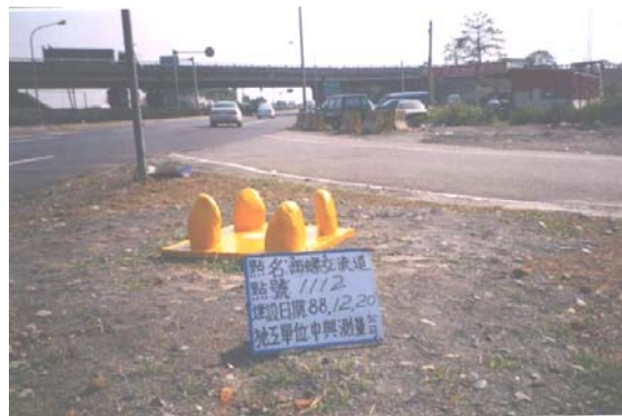
圖一：位於西螺交流道之一等一級水準點 (內政部地政司衛星測量中心， 基本控制測量成果資料查詢系統 ， http://www.moidlassc.gov.tw/ > (2008 年 8 月 14 日))
