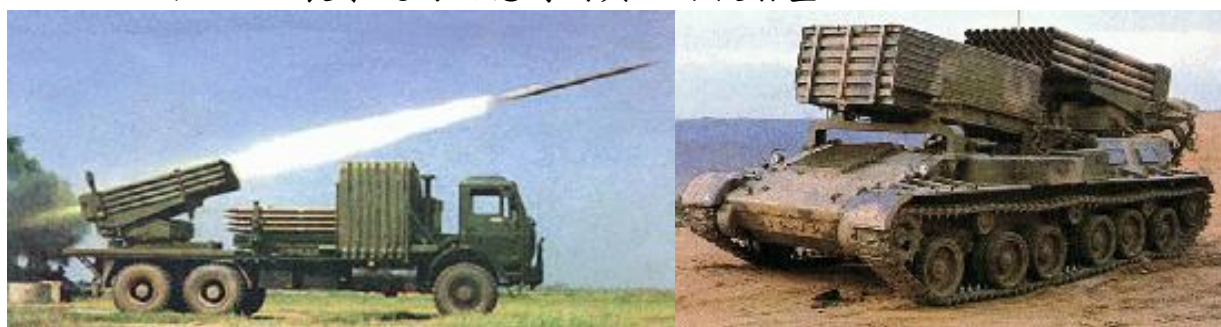
圖 5、中共 122 公厘多管火箭系統，仿製前蘇聯 BM-21 型 122 公厘多管火箭系統，改良後已大幅提升發射速度。
