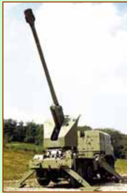
圖 25、B-52 輪型自走砲在做火力測試準備，該砲處於標準的“12 點鐘”射擊方向，且支撐架放下後，後輪已離開地面
