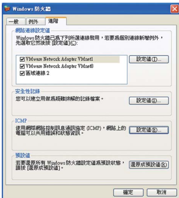
圖四 修改電腦內建防火牆對ICMP的設定值
