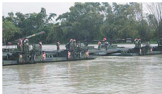
圖六 M3機動浮門橋
